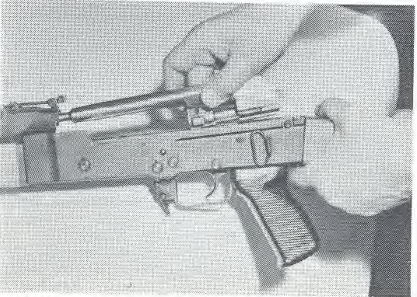
Sl. 63 – Vađenje nosača zatvarača sa klipom i zatvaračem
